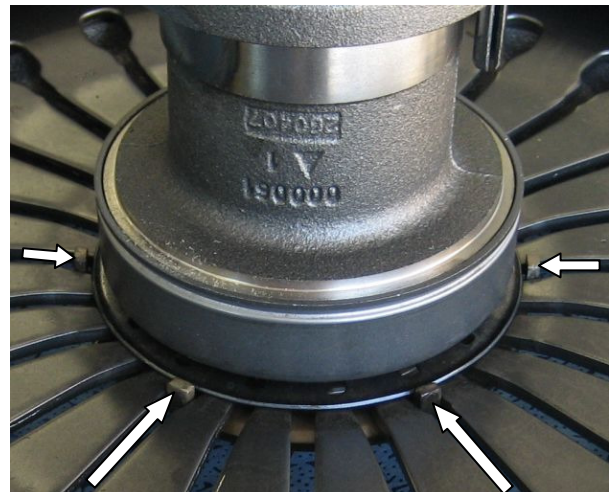
Fig. 3: Vista lateral de las espigas de guía (¡sólo son visibles cuatro de un total de seis!)
