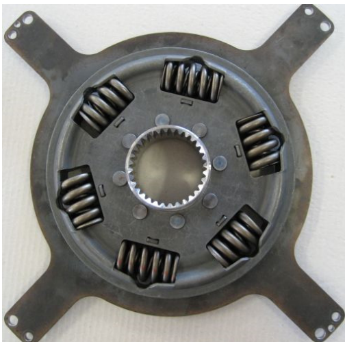
Fig. 2: amortiguador de torsión de la toma de fuerza
