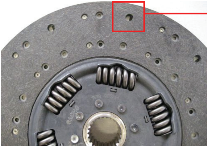
Fig. 1: Forro del lado del motor
