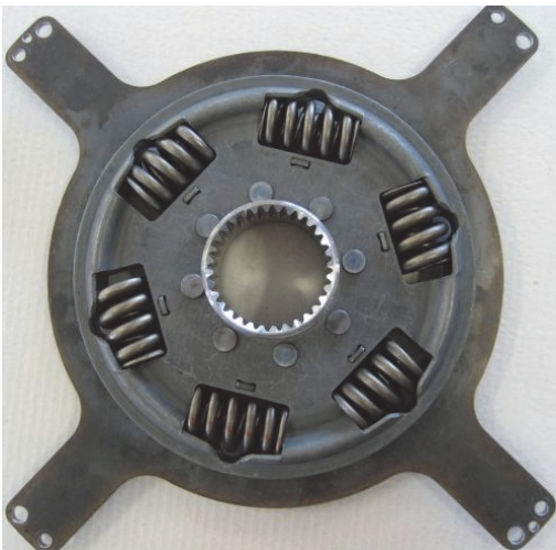
Sl. 2: Torzioni prigušivač sporednog pogona
