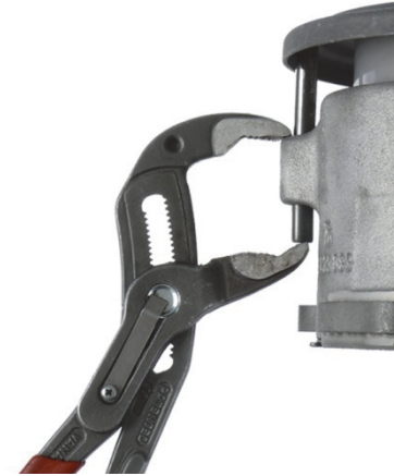
Рис.3: Установка просечных штифтов
