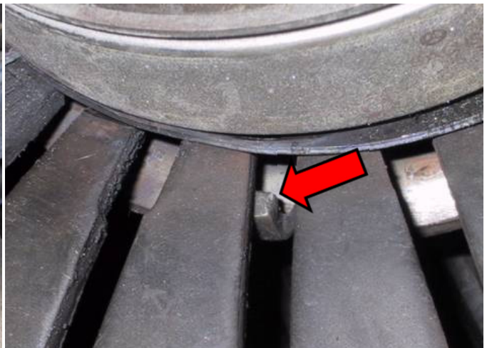
Рис. 2: Неправильное положение направляющих цапф кольца выжимного подшипника – цапфа соскользнула под лепесток диафрагменной пружины
