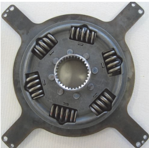
Рис. 2: Торсионный демпфер системы дополнительного отбора мощности
