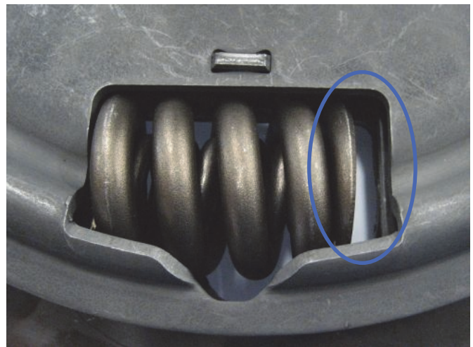
Рис. 3: Торсионная пружина с установленным зазором
