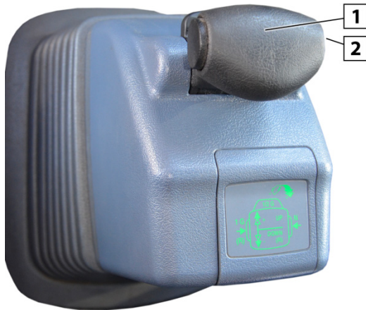
Fig. 1: Alavanca de seleção do EPS1
