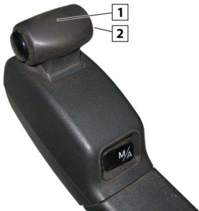
Fig. 3: Alavanca de seleção do EPS2
