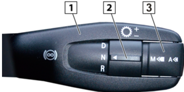
Fig. 5: Alavanca de seleção do EPS3
