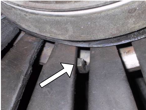
Fig. 1: Assentamento incorrecto dos dentes guia do anel de engate – O dente está preso sob a mola da membrana
