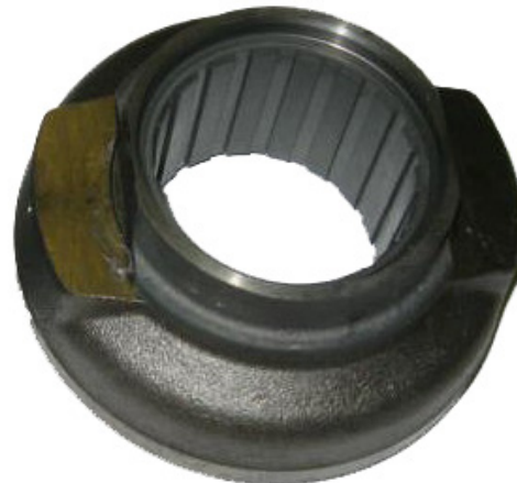
Fig. 4: Dispositivo de desembraiagem com casquilho deslizante em plástico
