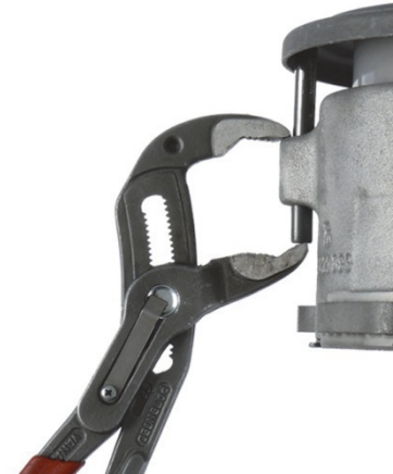
Fig.3: Innstilling av riflepinne
