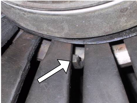
Afb. 1: Verkeerd zittende geleidepen van de koppelingsdrukklager – hier is de pen onder de membraanveer verschoven
