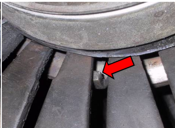
Sl. 2: Pogrešan položaj vodećeg rukavca prstena odvajača – rukavac je skliznuo ispod membranske opruge
