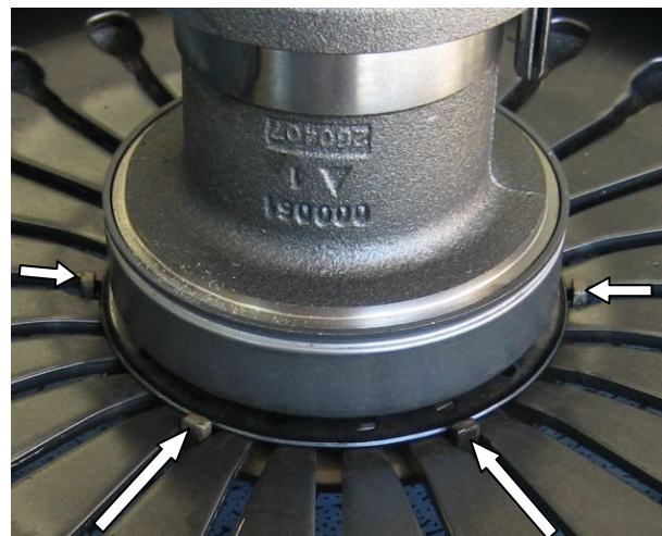
Fig. 3: Prospettiva laterale dei perni di guida (solamente 4 dei 6 perni complessivi sono visibili)
