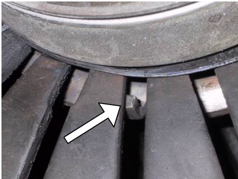
Fig. 1: Sede errata dei perni di guida dell'anello di disinnesto – Il perno è scivolato i sotto la molla a membrana
