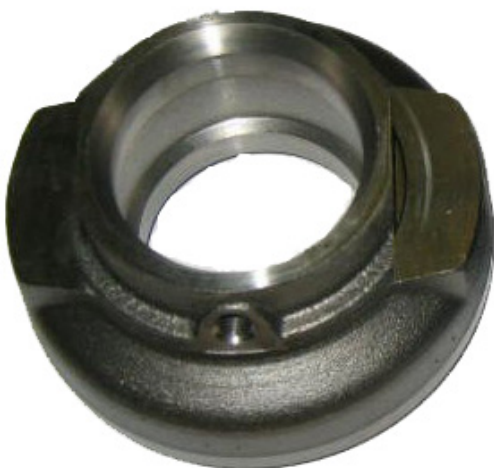
Fig. 3: Reggispinta con manicotto scorrevole in metallo
