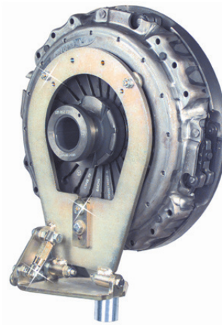
Εικ. 3: Βοήθημα τοποθέτησης Πλάκα πίεσης Blitz Rotary αριθμ. προϊόντος 101758
