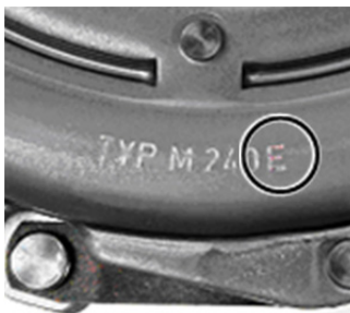
Fig. 2: Todos los embragues Xtend llevan la letra adicional E . Ejemplo: M 240 E
