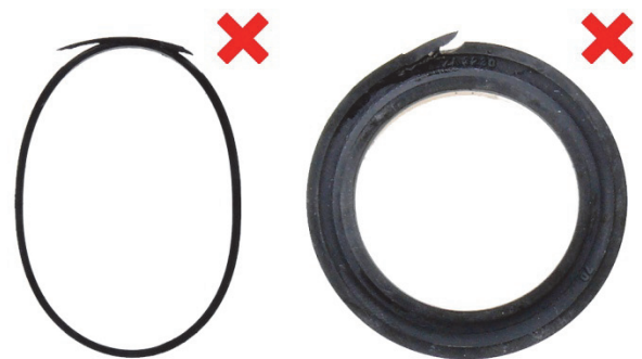
Fig. 6: junta de estanqueidad (2) dañada
