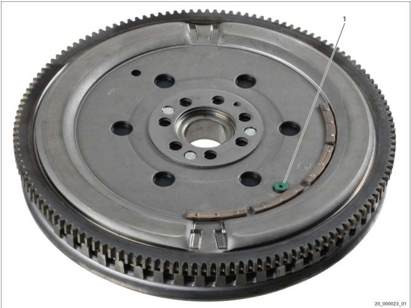
Fig. 1: volante bimasa con seguro para el transporte
