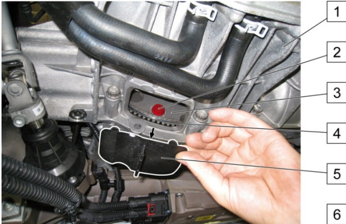
Fig. 1: Desmontaje de la cubierta (5)
