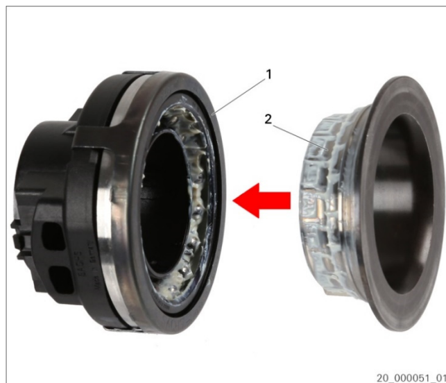
Sl. 2: Postavljanje prstena za zaletanje
