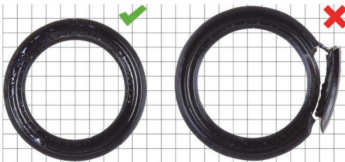
Slika 4: Novi usni zaptivni prsten (1)
