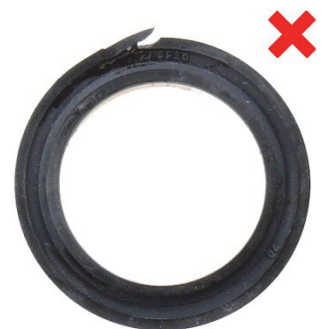
Slika 7: Usni zap. prsten (1) narezan
