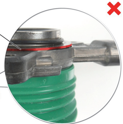
Slika 3: Pritisna čahura istisnuta iz zaptivača
