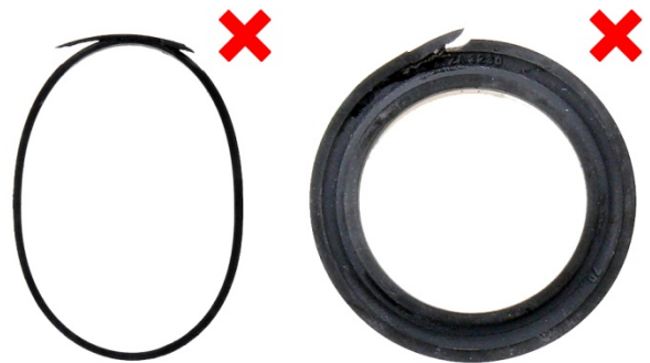
Рис. 6: Уплотнительное кольцо (2) повреждено
