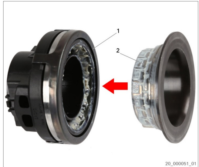
Рис. 2: Установка упорного кольца
