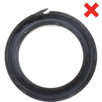
Fig. 7: Anel vedante de lábio (1) com ruptura (cisalhamento)
