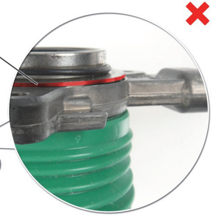
Fig. 3: Casquilho de deslizamento pressionado para fora do calcamento
