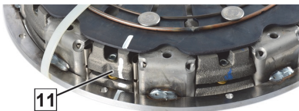
Fig. 6: Marcação na carcaça da embreagem
