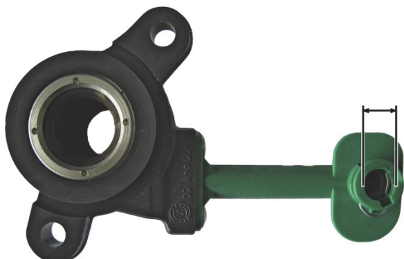
Sl. 1: CSC 3182 600 121 → 3182 654 165 Promjer hidrauličkog priključka 11,7 mm
