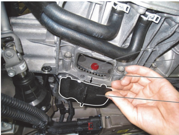
Sl. 1 Demontaža pokrova (5)
