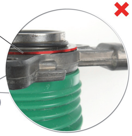
Fig. 3: rimozione del manicotto scorrevole dalla cianfrinatura
