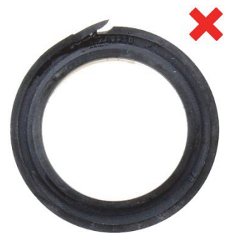
Fig. 7: Anello di tenuta a labbro (1) reciso
