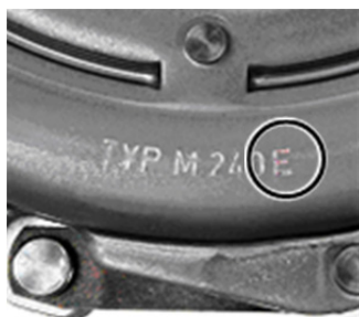
Fig. 2: Su tutte le frizioni Xtend è indicata la lettera di riferimento supplementare E . Esempio: M 240 E
