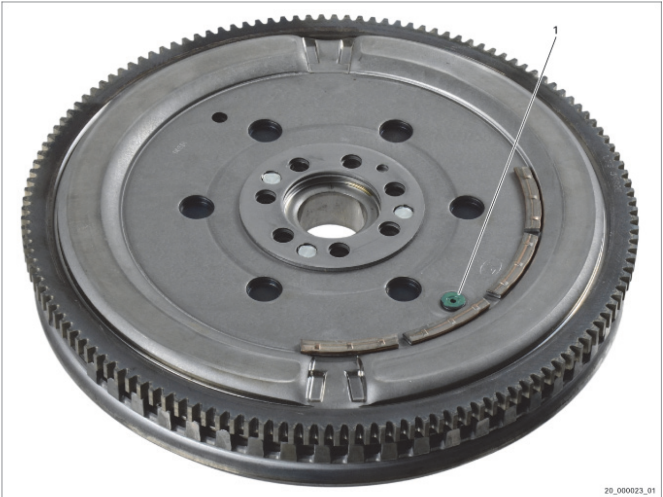
Εικ. 1: Σφόνδυλος διπλής μάζας με ασφάλεια μεταφοράς
