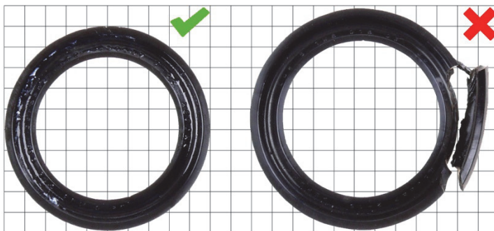
Fig. 4: joint à lèvres d'étanchéité neuf (1)
