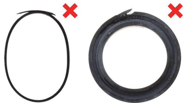
Fig. 6: bague d'étanchéité (2) abîmée
