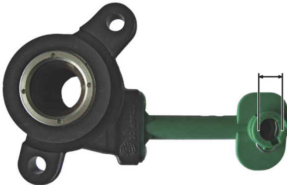
Fig. 1 : CSC 3182 600 121 → 3182 654 165 Diamètre du raccord hydraulique : 11,7 mm
