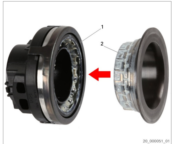
Kuva 2: Vasterengkaan laittaminen paikalleen
