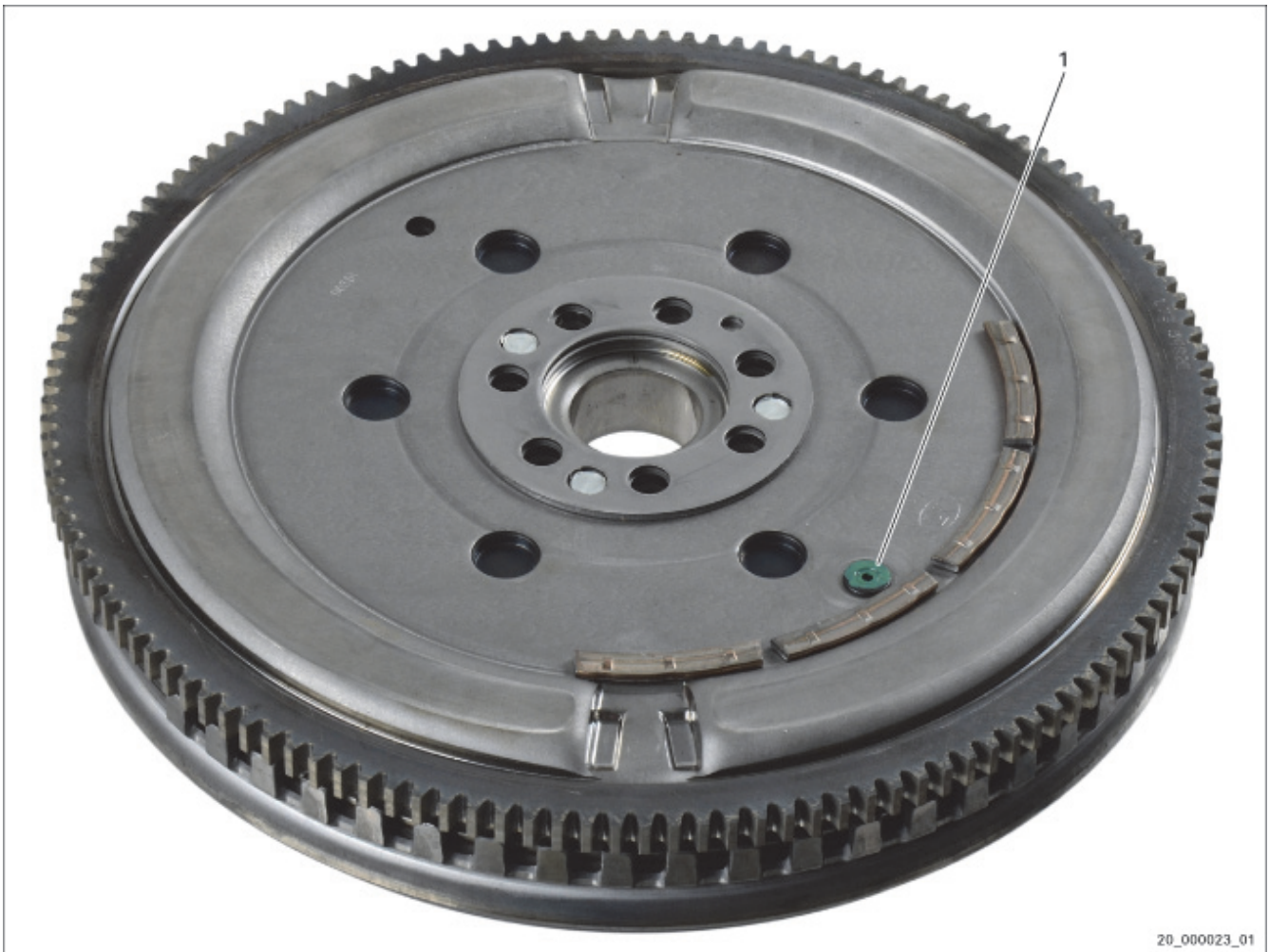
Фиг. 1: Двумасов маховик с транспортна защита
