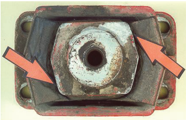
Fig. 2: Desgaste en una pieza de caucho metal
