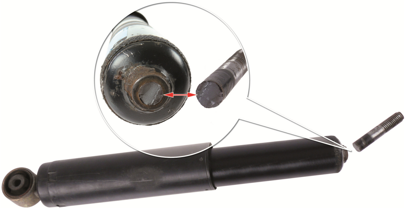
Рис. 1: Излом шарнира под действием переменной изгибающей нагрузки
