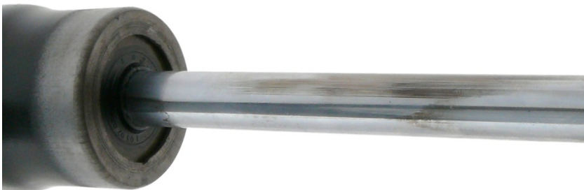
Рис. 2: Односторонний износ хромового покрытия штока вследствие неправильной установки (монтаж с перекосом)
