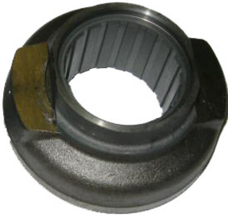
شكل 4: وحدة فصل تعشيق ذات كم منزلق بلاستيكي
