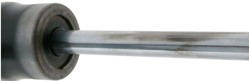
Fig. 2: Revêtement chromé de la tige de piston par montage à mauvais serrage usure unilatérale
