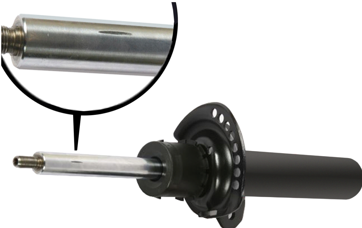
1. Ábra: Hornyos dugattyúrúd
