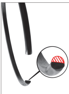
Fig. 3 : Usure du circlip.
