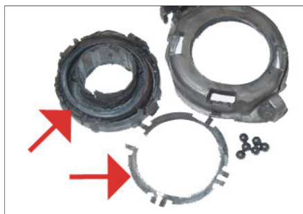
Fig. 4 : Dommages mécaniques et surchauffe sur la butée de débrayage
