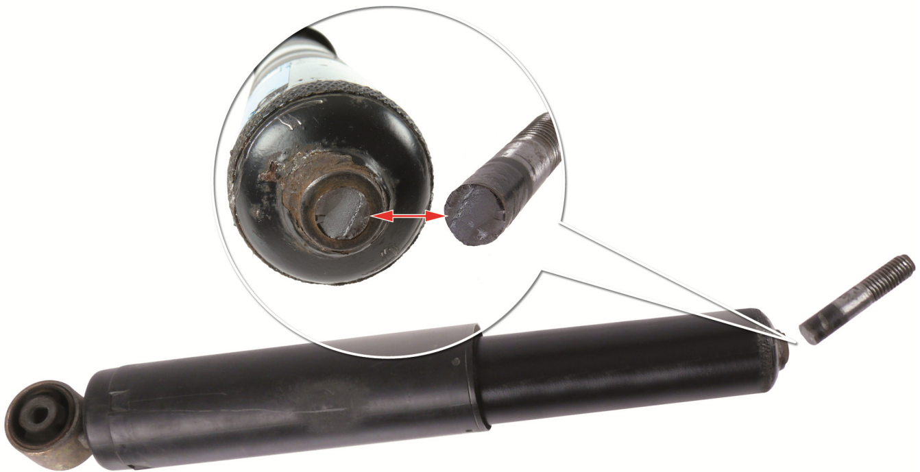
Sl. 1: Zlomljen zgibni del zatiča zaradi spreminjanjoče se upogibalne obremenitve
