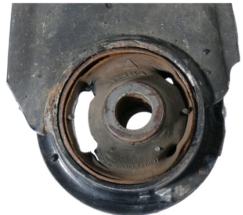
Sl. 3: Poškodba gumijasto-koviskega ležaja
