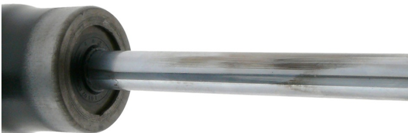
Sl. 2: Kromirana plast batnice izrabljena na eni strani zaradi preveč napete vgradnje
