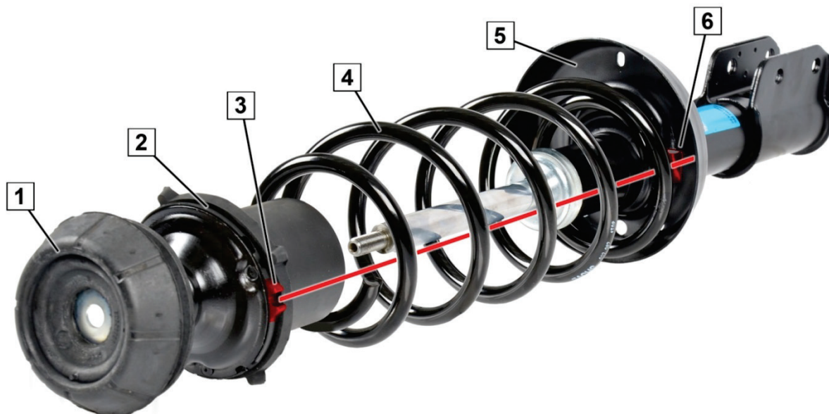
Obr. 1: Správně nastavená poloha opěrného ložiska pružící jednotky
