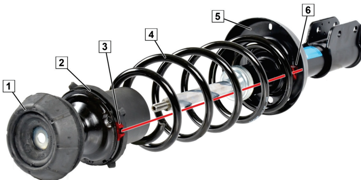
Obr. 1: Správne polohované tlmiace ložisko
