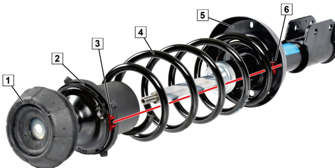
Slika 1: Ispravno pozicionirani potporni ležaj gibnja
