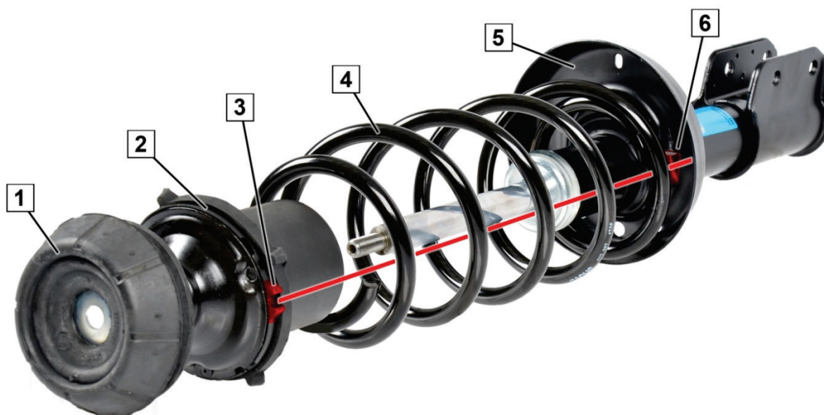
Bild 1: Fjäderbensstödlager korrekt positionerat
