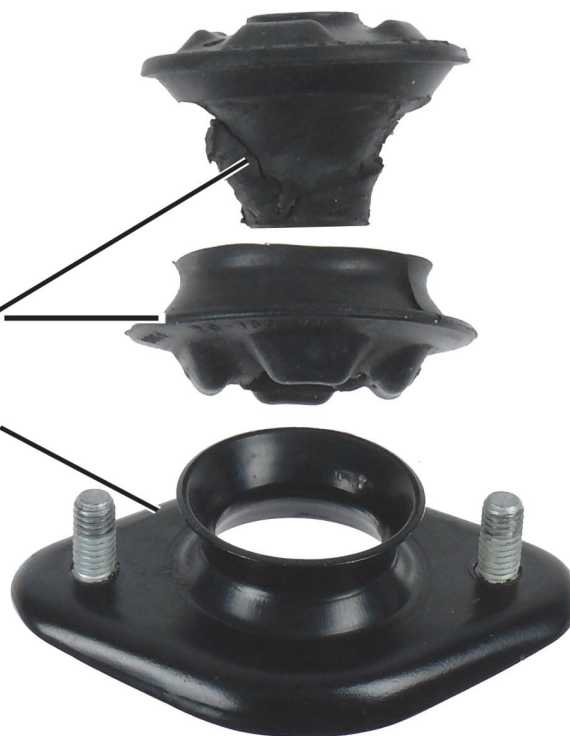
Рис. 2. Повреждённая верхняя опора амортизационной стойки
