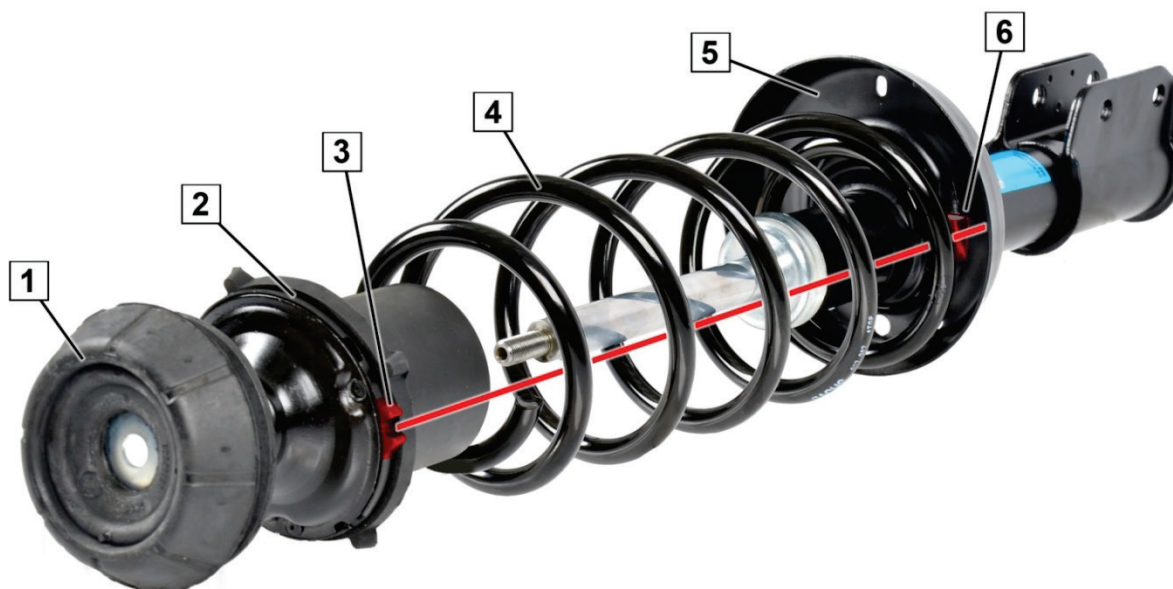
Fig. 1: Poziționarea corectă a rulmentului de sarcină
