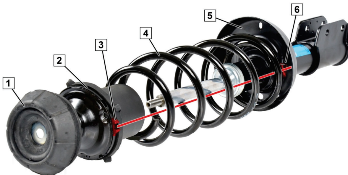
Εικ. 1: Έχει τοποθετηθεί σωστά το έδρανο γόνατου ανάρτησης
