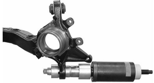
Fig. 6: Insérer le palier élastique
